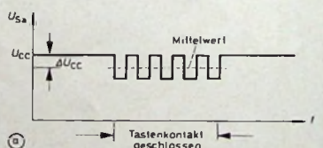
Bild 2. Spannungen an der Sammelschiene: a) ohne Bounce-Ausgleich, b) mit Bounce-Ausgleich
